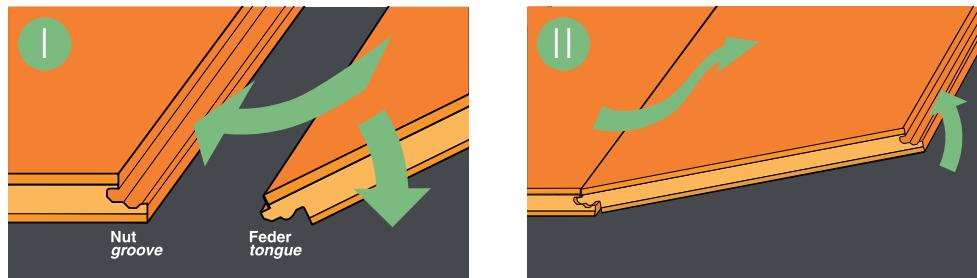
Benutzen Sie ausreichend Holzkeile, um die Dehnungsfuge während der Verlegung zu fixieren. Es ist zu empfehlen, die Dielen längs zum Hauptlichteinfall zu verlegen, in länglichen, schmalen Räumen ist immer eine längsseitige Verlegerichtung empfehlenswert. Ferner sollten Sie an einer geraden Wand des Raumes beginnen.
